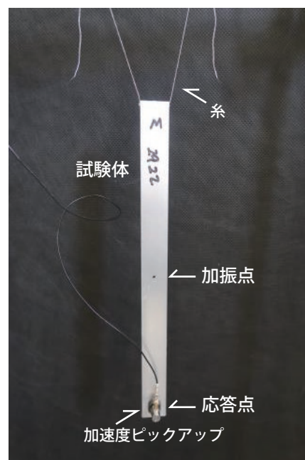
試験体の支持状況
