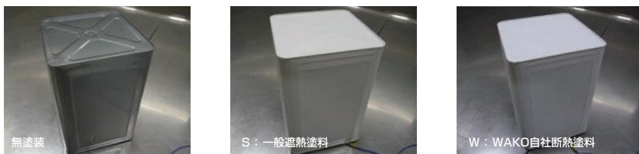
写真1 試験用の試験体
