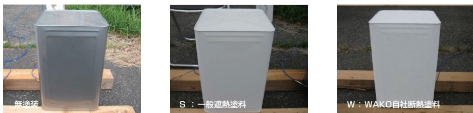
写真1 屋外試験用の試験体
