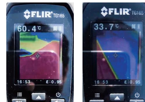
図2 前試験での塗装有無による鋼板表面温度の差異
