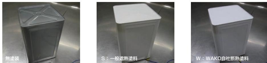
写真1 試験用の試験体
