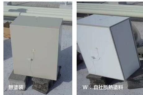
写真1 屋外試験用の試験体
